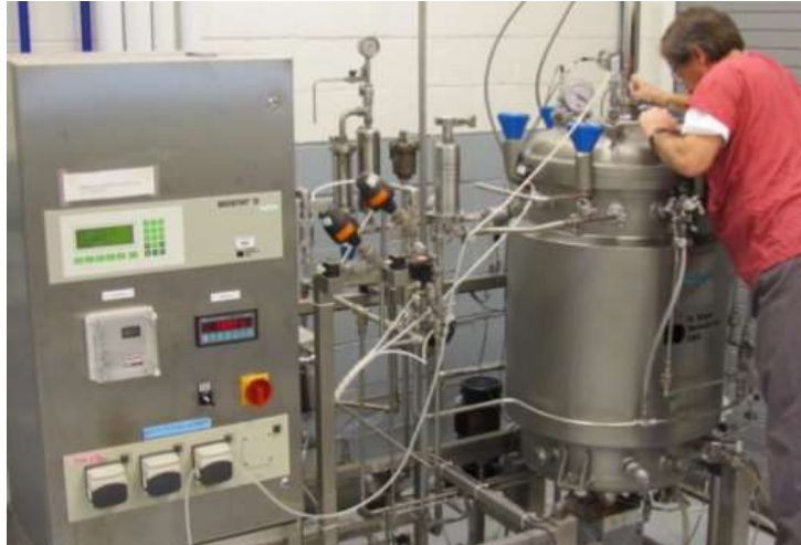
Un gran fermentador de 1500 L. Crédito de fotos: Dugway Proving Ground
